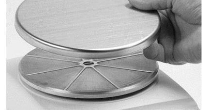
Lắp đặt mặt đĩa cân
