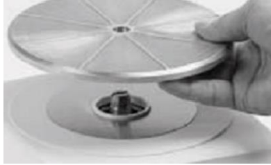
Lắp đặt đế đỡ đĩa cân
